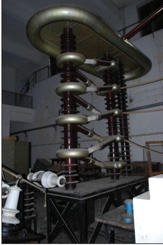
I.Ü. Fen Fakültesi'nin Cockcroft-Walton hızlandırıcısının kondansatörleri (Fotoğraf: Kaan Ata, 04.11.2008)
