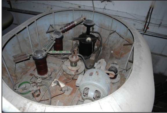
İ.Ü. Fen Fakültesi'nin Cockcroft-Walton hızlandırıcısında "şapka"nın içi: İyon kaynağı, dinamo, transformatör ve supaplar (Fotoğraf: Kaan Ata, 04.11.2008)
