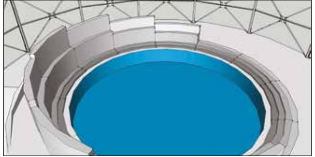
Şekil 9: Yükselerek kapalı havuz olarak kullanımını sağlayacak çeper duvarları (E. Türkel, 2017). / Outer walls rising up to form an indoor swimming pool (E. Türkel, 2017).
