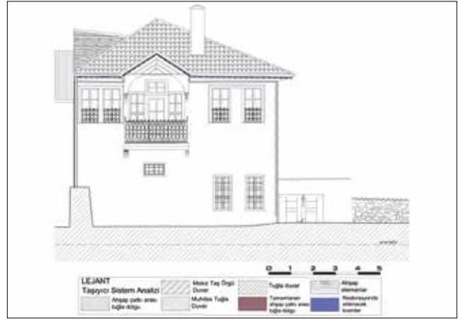
Şekil 24. Kuzeydoğu görünüşüne ait restorasyon projesi / Restoration project of the northeastern façade
