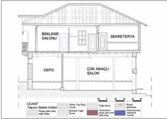
Şekil 21. 3-3 kesitine ait restorasyon projesi / Restoration project of the 3-3 section
