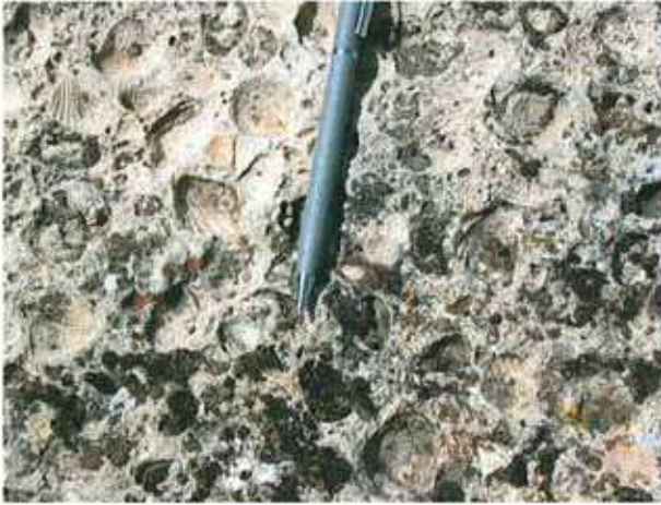
Res. 9. Tripolis stoasına ait büyük taş blokların yakın plan görünümü. Yaşlı Kolonkaya Formasyonu içindeki bol fosilli ( Cardium sp.) kumlu kireçtaşı ve karbonat çimentolu kumtaşı seviyeleri (gözl. no: L21JJ002).
