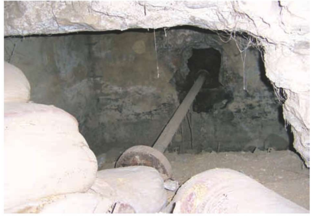
Res.31- Şamlılar Çeltik Fabrikası, mil yatağı ve çarka bağlanan metal mil
