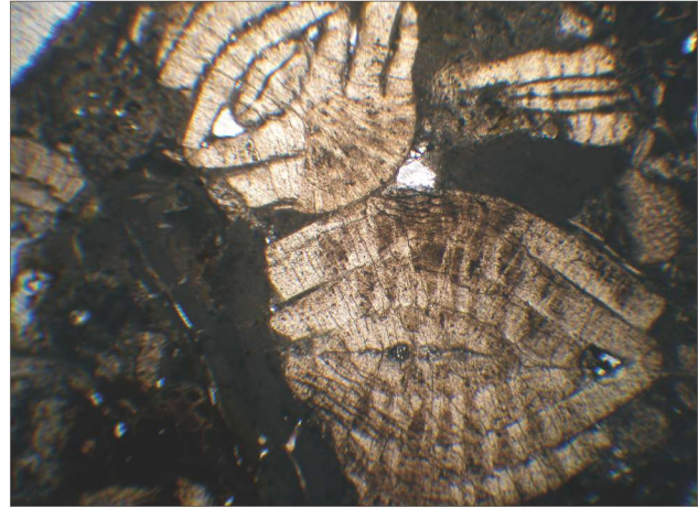
Res. 7. Kireçtaşının ince kesitinin polarizan mikroskop altındaki görünümü
