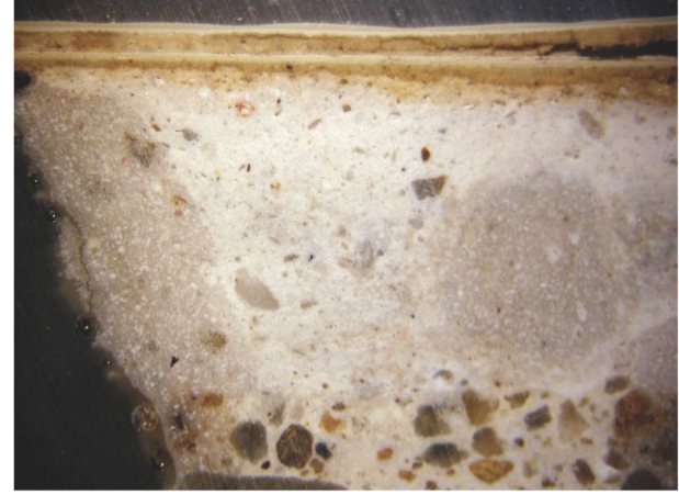
Res. 11. Harç ve üzerindeki boya katmanlarının stereo mikroskoptaki görünümü
