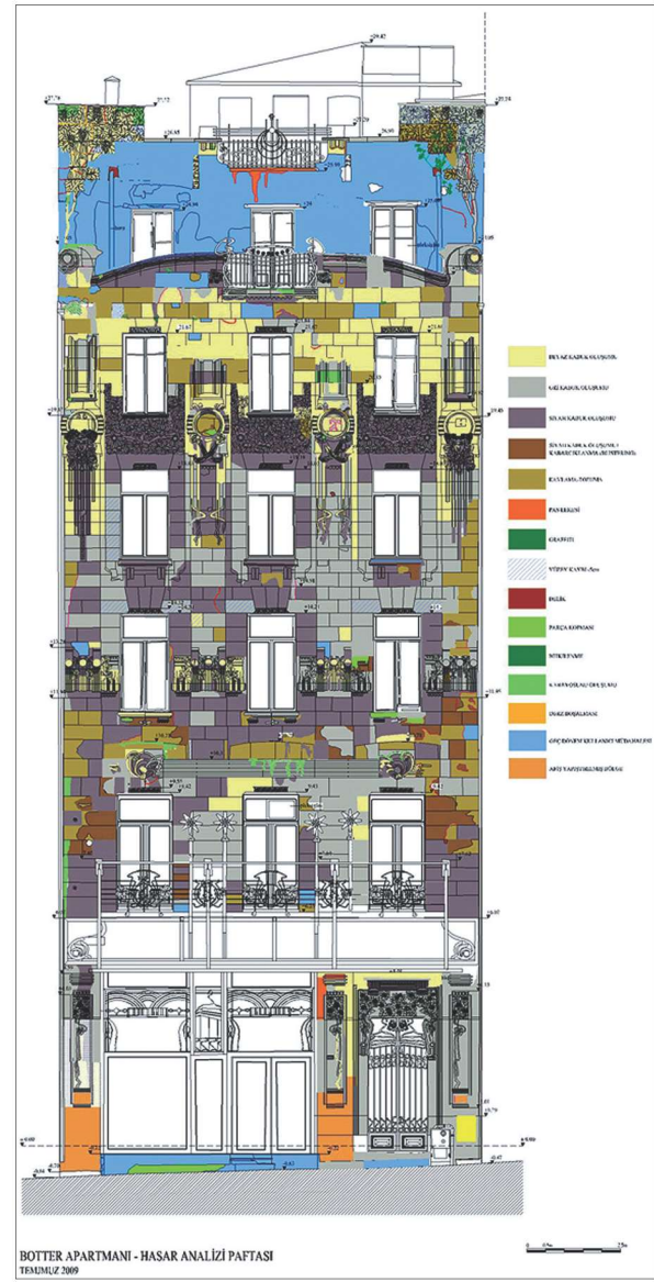
Res. 2. Botter Apartmanı hasar analizi paftası
