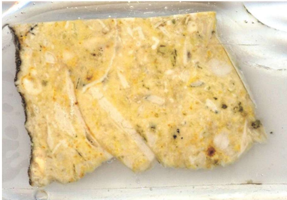
Res. 6. Kireçtaşının stereo mikroskoptaki görünümü
