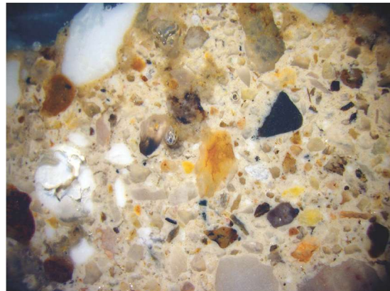
Res. 9. Kireç harcı örneğinin stereo mikroskoptaki görünümü
