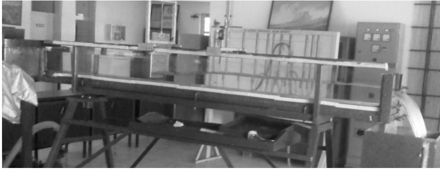
Şekil 2 - Deney kanalı ve düşey kapak önünde oluşan batmış hidrolik sıçrama
