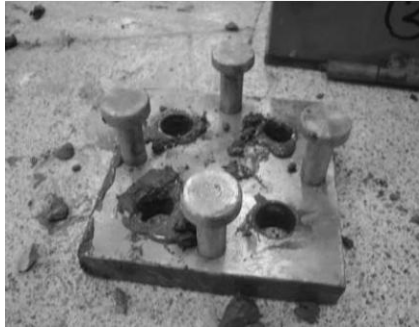
Şekil 2. Kütle kaybı deneyi için donatı yerleştirilmesinde kullanılan özel numune başlığı
