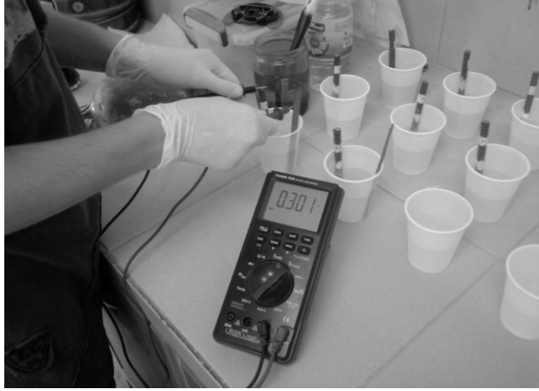
Şekil 4. Galvanik pil deneyinin yapılışı
