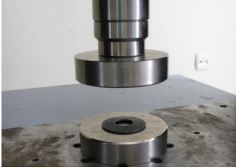
Şekil 2. Disk yayın basma test cihazında görünümü
