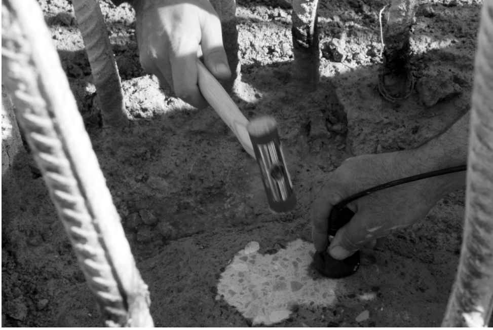
Şekil 7. Kazık süreklilik deneyi (Özüdoğru, 2007).
