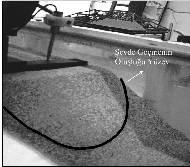
Şekil 7. Şevde Göçmenin Meydana Gelmesi
