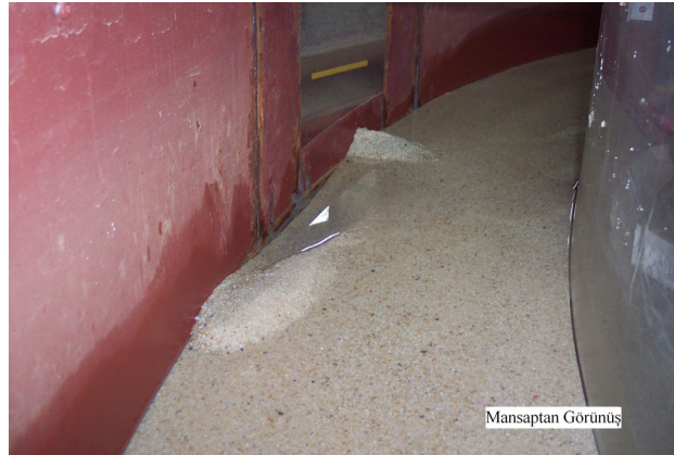
Şekil 17 V_1=0.38 m/s için taban topoğrafyasındaki değişimler
