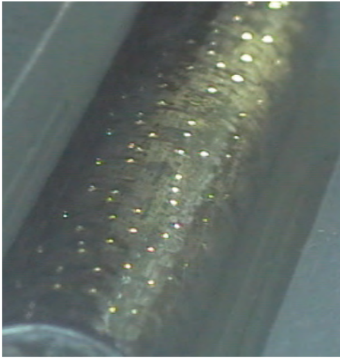
Şekil 3. Lif çekim işlemi esnasında silindir yüzeyinde oluşan Taylor konileri [36].
