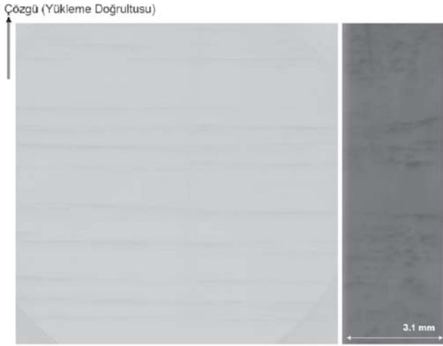
Şekil 8: \epsilon_3 seviyesindeki yüklemde x-rayda gözlenen enine çatlakların numune yüzeyinden ve kesitinden görülmesi
