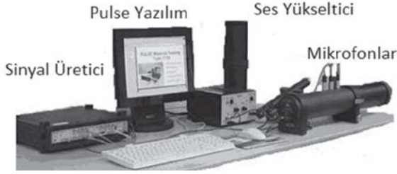
Şekil 8: Çift mikrofon empedans tüp yöntemi ölçüm düzeni
