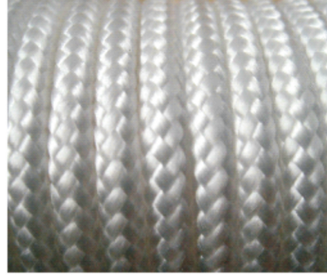
Şekil 5. Naylon içi dolu braid halat [4]
