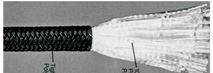
Şekil 9. Bir kısmı Z bir kısmı S bükümlü 3 kollu halatlardan oluşan çekirdek üzerine braid kılıf geçirilmiş [3]
