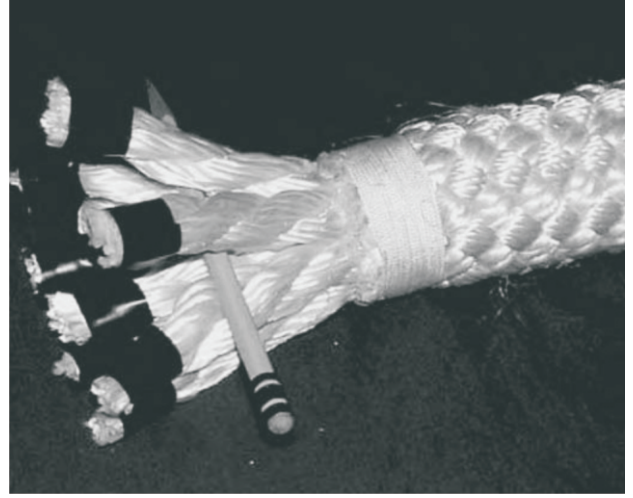
Şekil 8. Bir kısmı Z bir kısmı S bükümlü 3 kollu halatlardan oluşan çekirdek üzerine braid kılıf geçirilmiş [3]
