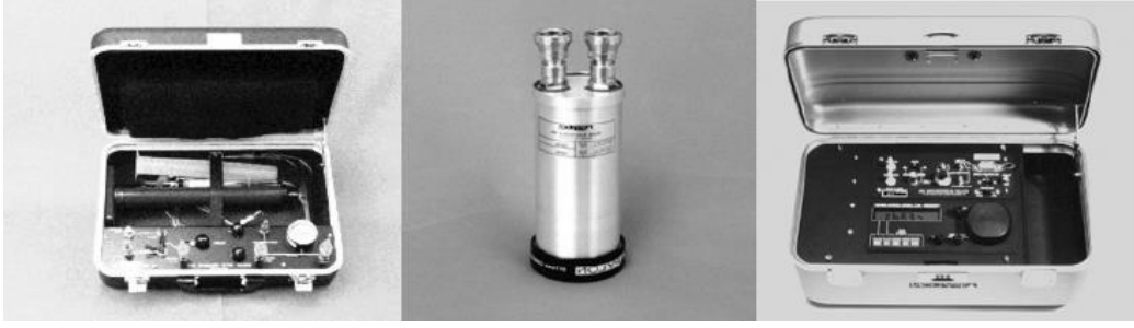
Şekil 2. Radon gazı ölçüm sistemi, sırasıyla AB-5R Detektörü, WG-1001 Gaz Ayrıştırma Ünitesi, Radon Depolama Hücresi (Pylon 1991).
