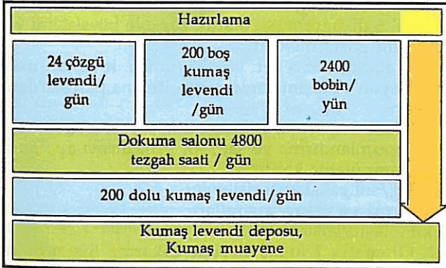
Şekil 4. Bir dokuma fabrikasında, bir örnek yardımıyla gösterilen malzeme akışı.
