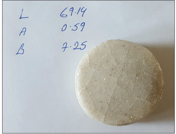
Şekil 5. Nefelinli siyenitin 1200°C'deki pişme rengi numunesi.
