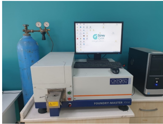
Őekil 3. Kimyasal analiz iŐleminin yapıldıđı Oxford Instruments marka kimyasal analiz cihazı
