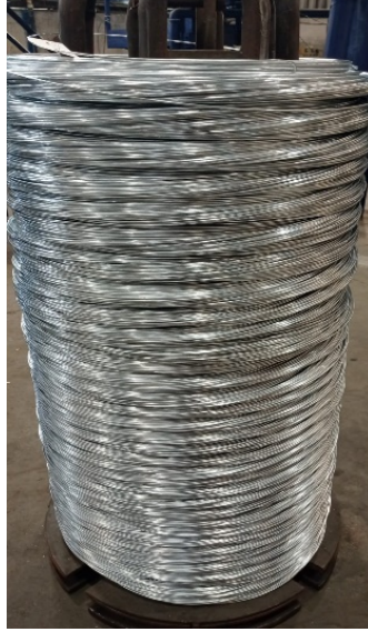
Őekil 7. Zn-Al-Sr alařımı ile kaplanmış elik tel
