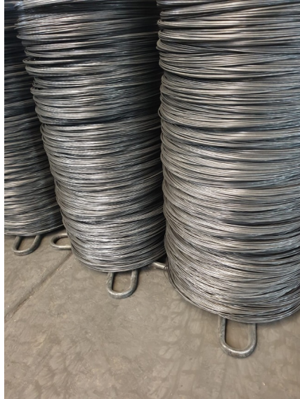
Şekil 6. Çapı 2.70 mm'ye düşürülmüş çelik teller
