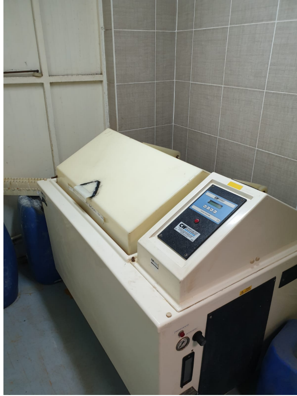
Őekil 8. Korozyon testlerinin yapıldıđı C+W specialist equipment limited marka sf/450a model tuz sisi cihazı
