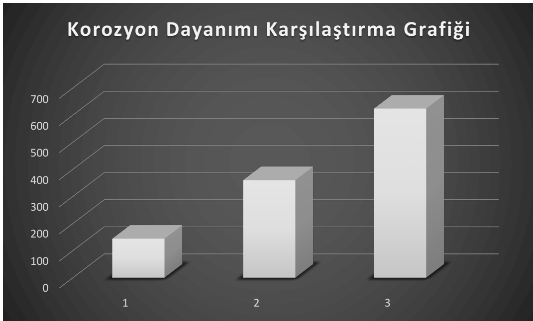
Şekil 10. Galfan, galvaniz, Sr içeren galfan alaşımlarının korozyon değerlerinin karşılaştırılması
