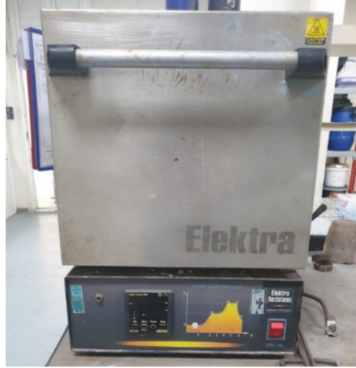
Şekil 1. Ergitme işleminin gerçekleştirildiği maksimum 1200°C kapasiteli elektra rezistans markalı kül fırını
