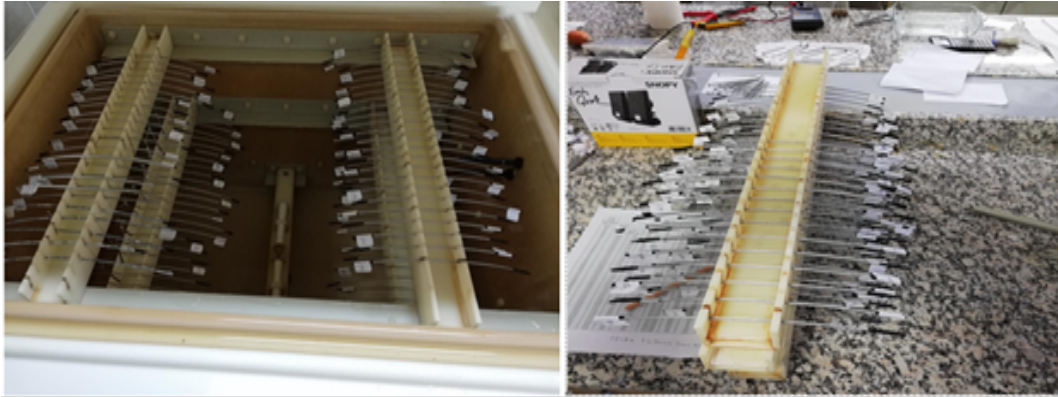
Őekil 9. Korozyon testi sonunda tuz sisi cihazından ıkarılmıř tellerden bir grnm
