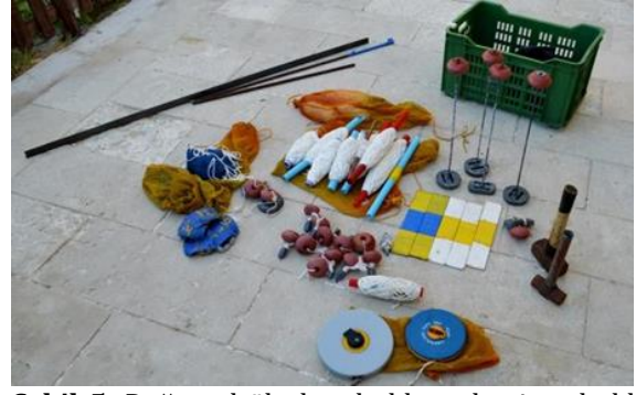
Şekil 5. Doğrusal ölçek çubukları, demir çubuklar, ölçüm bantları, şamandıralar, numaralı etiketler ve pusula (Abdelaziz ve Elsayed, 2019)
