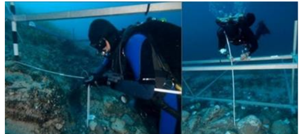
Şekil 24. Yer Kontrol Noktalarının tesisi (Costa, 2019; Bojakowski vd., 2015)
