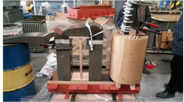
Şekil 11. Amorf çekirdekli prototip transformatör imalatı
