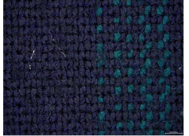
Şekil 13. Boncuklanma testinden sonra 40 g/l PVPA uygulanmış K-4'ün yüzey görüntüsü (Surface image of K-4 treated with 40 g/l PVPA after pilling test)
