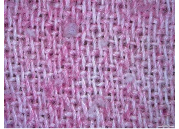
Şekil 8. Boncuklanma testinden sonra işlemsiz K-2'nin yüzey görüntüsü (Surface image of untreated K-2 after pilling test)
