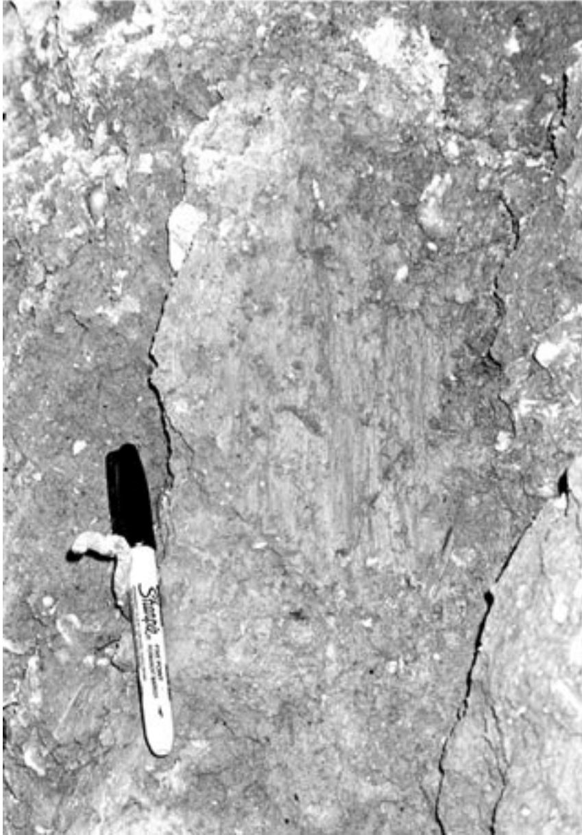
Şekil 10. Çay-2 hendeğindeki güncel fay yüzeyinde düşey kayma çizikleri.
