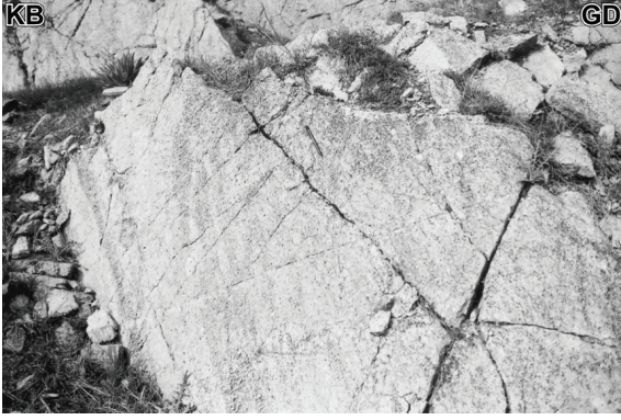
Şekil 7. Temele ait andezitlerde kayma yüzeyi, (lokasyon için Şekil 2'ye bakınız).
