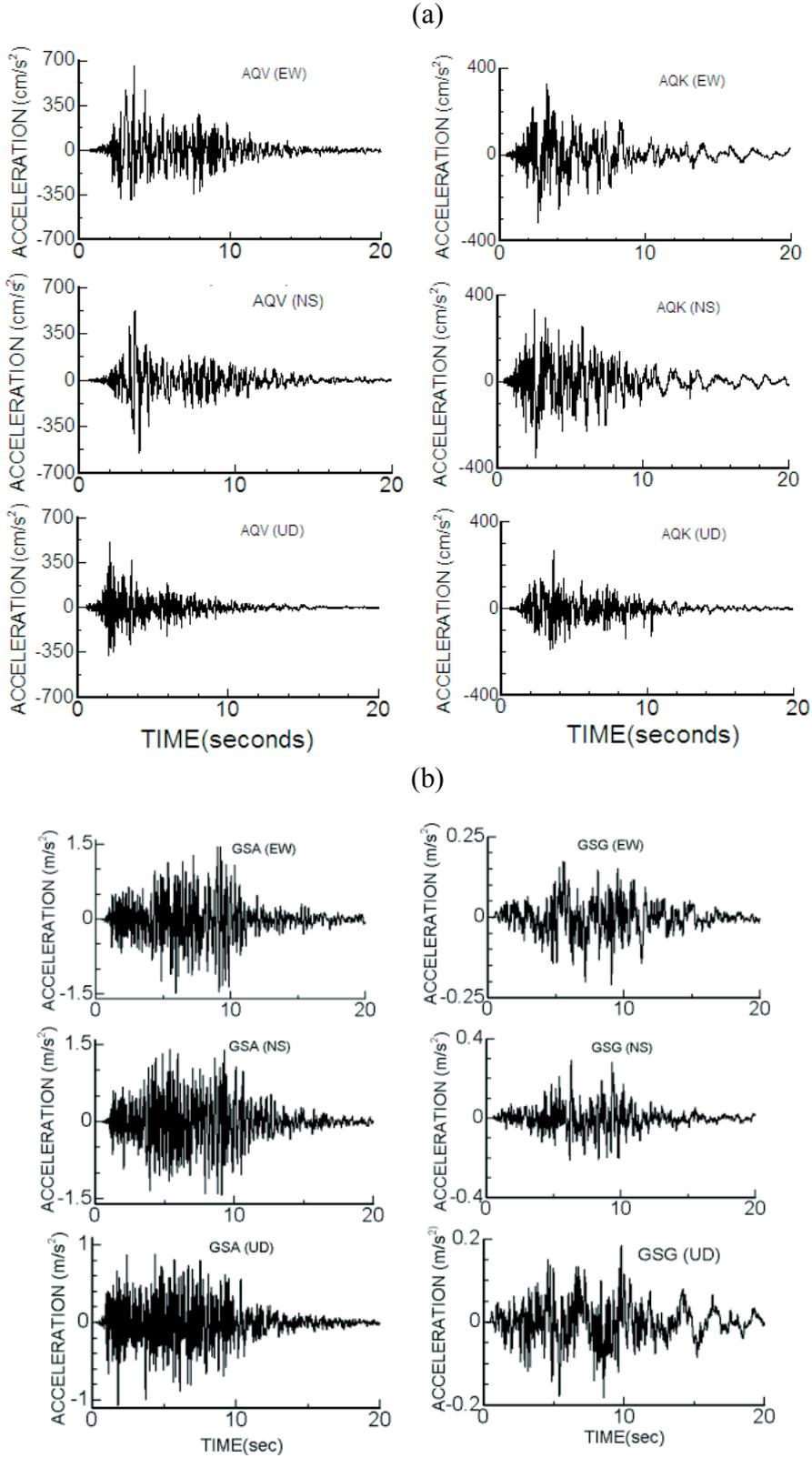
Şekil 8. (a) AQV ve AQK ve (b) GSA ve GSG kuvvetli yer hareket istasyonlarında alınmış ivme kayıtları.
