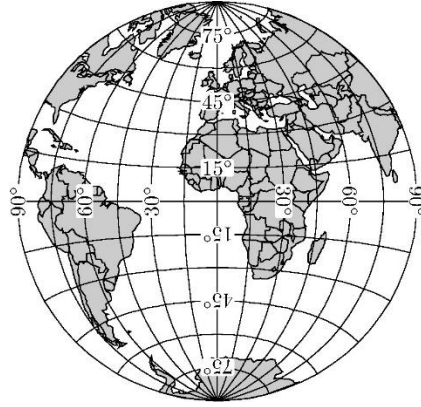
Şekil 3: Uzunluk koruyan transversal azimutal projeksiyon
