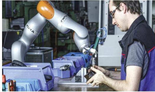
Şekil 4. Montaj prosesinde Kobot – İnsan işbirliği
