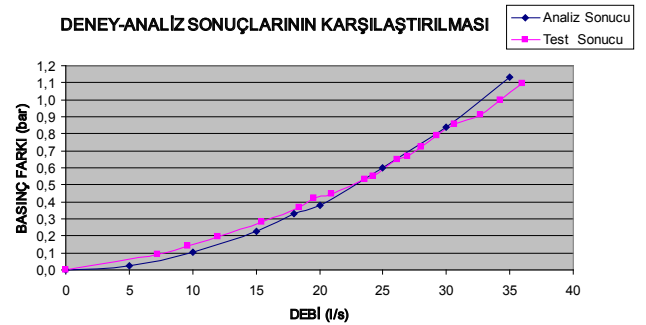
Şekil 9. Maça Kum Boyutu 0,065 mm Olan Modelin Analiz ve Deneysel Sonuçlarının Karşılaştırılması
