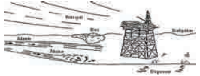
Şekil 2. Açık deniz yapılarına etkiyen çevre yükleri
