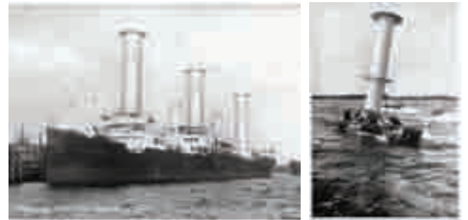
Şekil 23. Rotorlu gemi Barbara ve Flettner’in rotorlu yat uygulaması [7]
