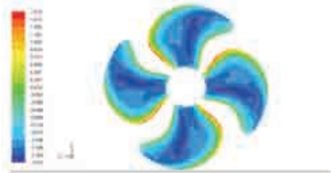
Şekil 12. Boyutsuz basınç dağılımları ( C_p ) (Podsuz-sırt)
