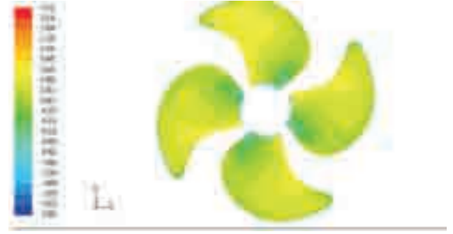
Şekil 15. Boyutsuz basınç dağılımları ( C_p ) (Podlu-yüz)
