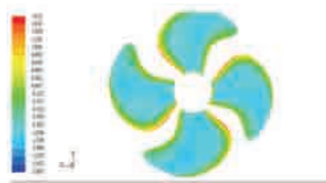
Şekil 14. Boyutsuz basınç dağılımları ( C_p ) (Podlu- sırt)
