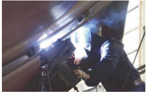
Şekil 5. Gemi sanayinde lazer kaynak uygulamalarına ait örnekler (BIAS, Bremen)
