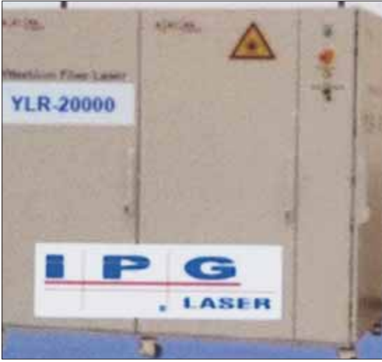
Şekil 6. 20 kW gücünde fiber lazer kaynak makinesi, görünümü ve bazı özellikleri
