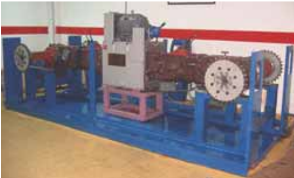
Fotoğraf 3.4. Aktarma üniteleri test aracı.
