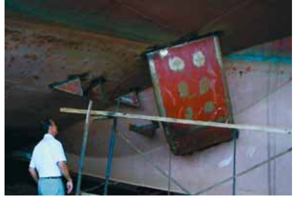
Fotoğraf 1. Gemi kıçına yerleştirilmiş girdap yaratıcılar ve iz düzeltici lüle.
