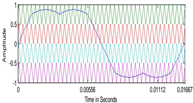
Fig. 4. PD-SFO PWM Modulation
