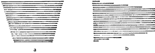
Şekil-9 Eşkenar Yamuk bozulması
