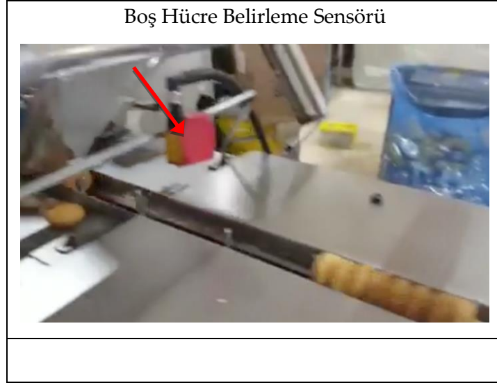
Şekil-2.2: Boş Hücre Belirleme Sensörü ve Hava Üfleme Aparatı
