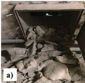
Şekil 9. Yüksek rutubetli malzeme beslenilmesi sonucu silo ve klapelerin bloke olması
