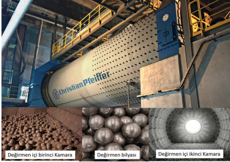
Şekil 11. Endüstriyel tip bilyalı çimento değirmeni
