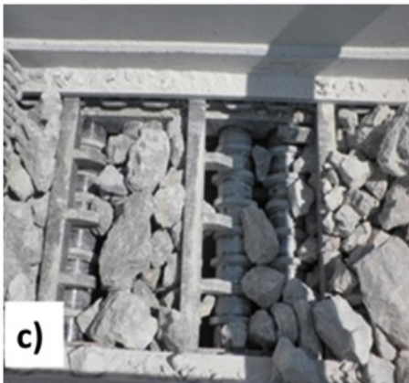
Şekil 6. Kırıcıya yüksek rutubetli malzeme beslenmesi sonucu ortaya çıkan problemler
