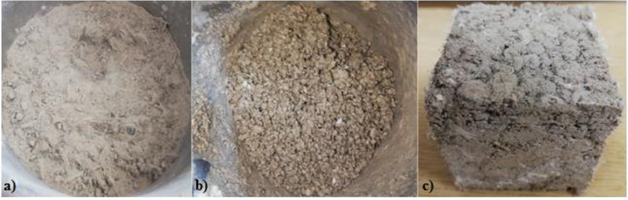
Şekil 3. Lifli geopolimer beton üretimi; a) Kuru karışım, b) Taze lifli geopolimer beton, c) Sertleşmiş lifli geopolimer beton numunesi
