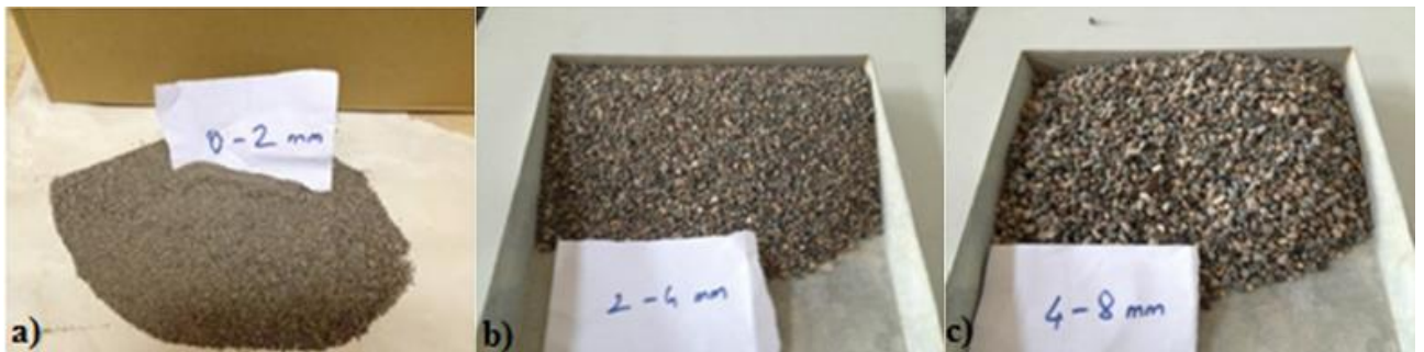
Şekil 1. Dere agregatı; a) 0-2 mm, b) 2-4 mm, c) 4-8 mm
