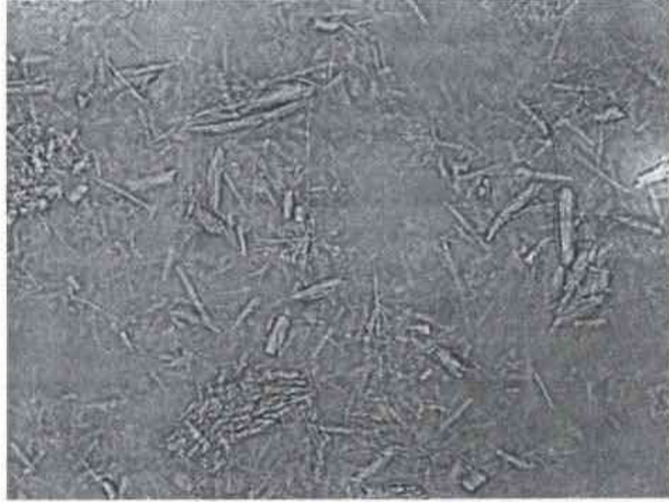
Şekil 10. Aktinolit asbestin mikroskopik görünümü ve kristal yapısı.
