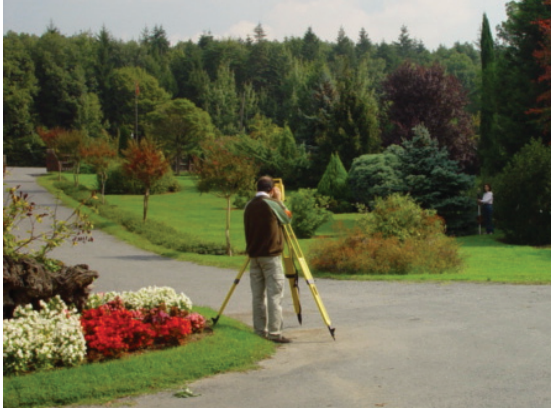
Şekil 2- Totalstation ile bitki konumlarının ölçülmesi
