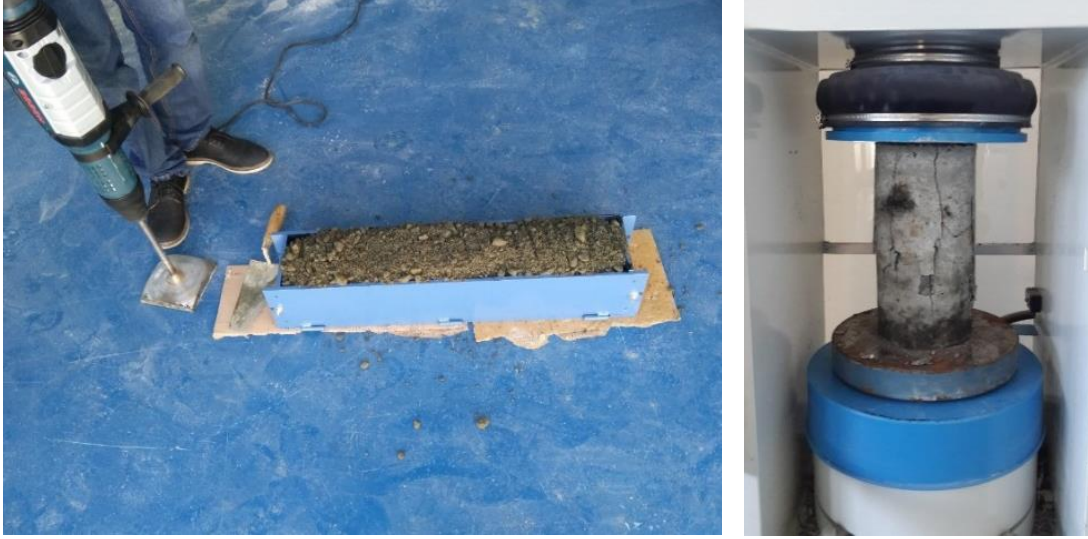
Şekil 3. SSB kiriş örneğinin vibratörlü çekiç ile sıkıştırma öncesi ve silindir numunenin basınç presi ile kırılma sonrası görüntüsü
