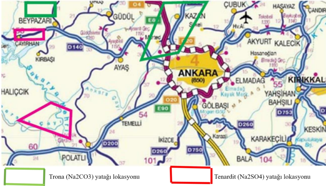
Şekil 7. Önemli trona ( \text{Na}_2\text{CO}_3 ) ve tenardit ( \text{Na}_2\text{SO}_4 ) yatakları rezervlerinin lokasyonları Kırıkkale ve önerilen Samsun petrol rafinerilerine yakındır. Bu kimyasal tuzlar, çözeltili madencilik ve boru hatlarıyla kimya tesislerine taşınabilir (T.C. karayolları haritası).
