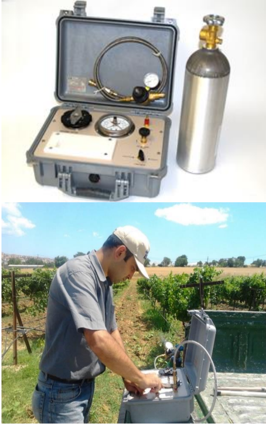
Şekil 2. Basınç odası (yaprak su potansiyeli ölçüm cihazı)
