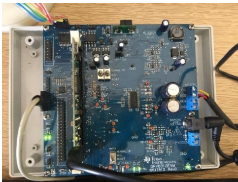
Şekil 21. TI TMS320F28069 DSP ve 8312 sürücü entegreli FDAM sürücü devresi
