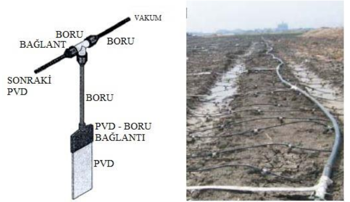
Şekil 8. Vakum ile ön yükleme uygulaması. (Yan ve diğ., 2009)
