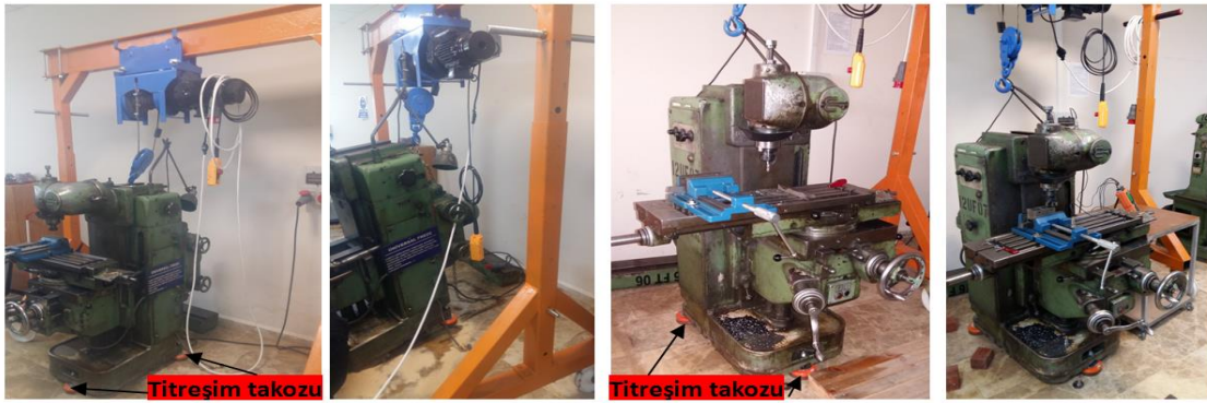
Şekil 2. Titreşim takozunun yerleştirilmesi (Placing of vibration wedge)
