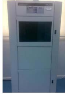
Şekil 13. Işık haslıđı test cihazı - ATLAS marka Xenotest ALPHA model (Ç.Ü. Tekstil Mühendisliđi Bölümü)
