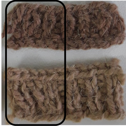
Şekil 14. Işık haslıđı test cihazında kumaşın ışığa maruz kalan bölümü (Üst; Ham fıstık kabuđu ile boyanmıř numune, Alt; Kavrulmuř fıstık kabuđu ile boyanmıř numune,)
