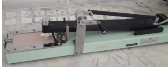
Şekil 8. Sürtme haslığı test cihazı- Crockmeter (Ç.Ü. Tekstil Mühendisliği Bölümü)
