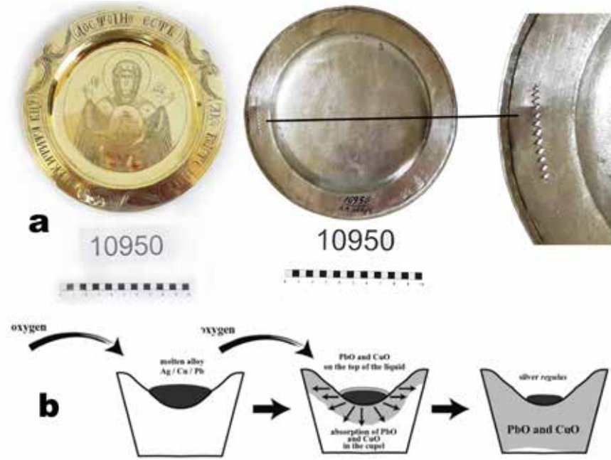
Resim 4: Civa Yıldızı (Amalgam) ile Kaplanmış Gümüş Tabakta Kuplasyon Kazıma Çizgileri (a) ve Kuplasyon İşleminin Şematik Gösterimi (b). Fotoğraf: Şirin KAYA ve Irmak Güneş YÜCEİL; Şema (Torres, Thomas ve Aude Mongiatti, 2008: s. 60)
