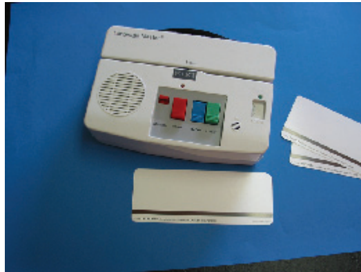
Şekil 1: Manyetik kart okuyucu ve manyetik ses kartları
