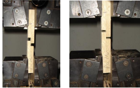
Şekil 2.Deney düzeneği ve çekme deneyine maruz kalan örnekteki değişim
