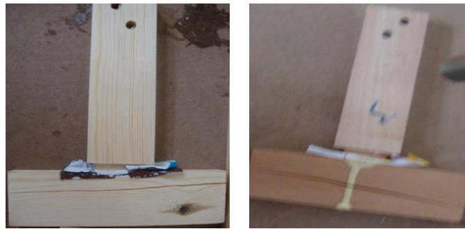
Şekil 6. Deneylerde gözlenen üçüncü tip deformasyon
